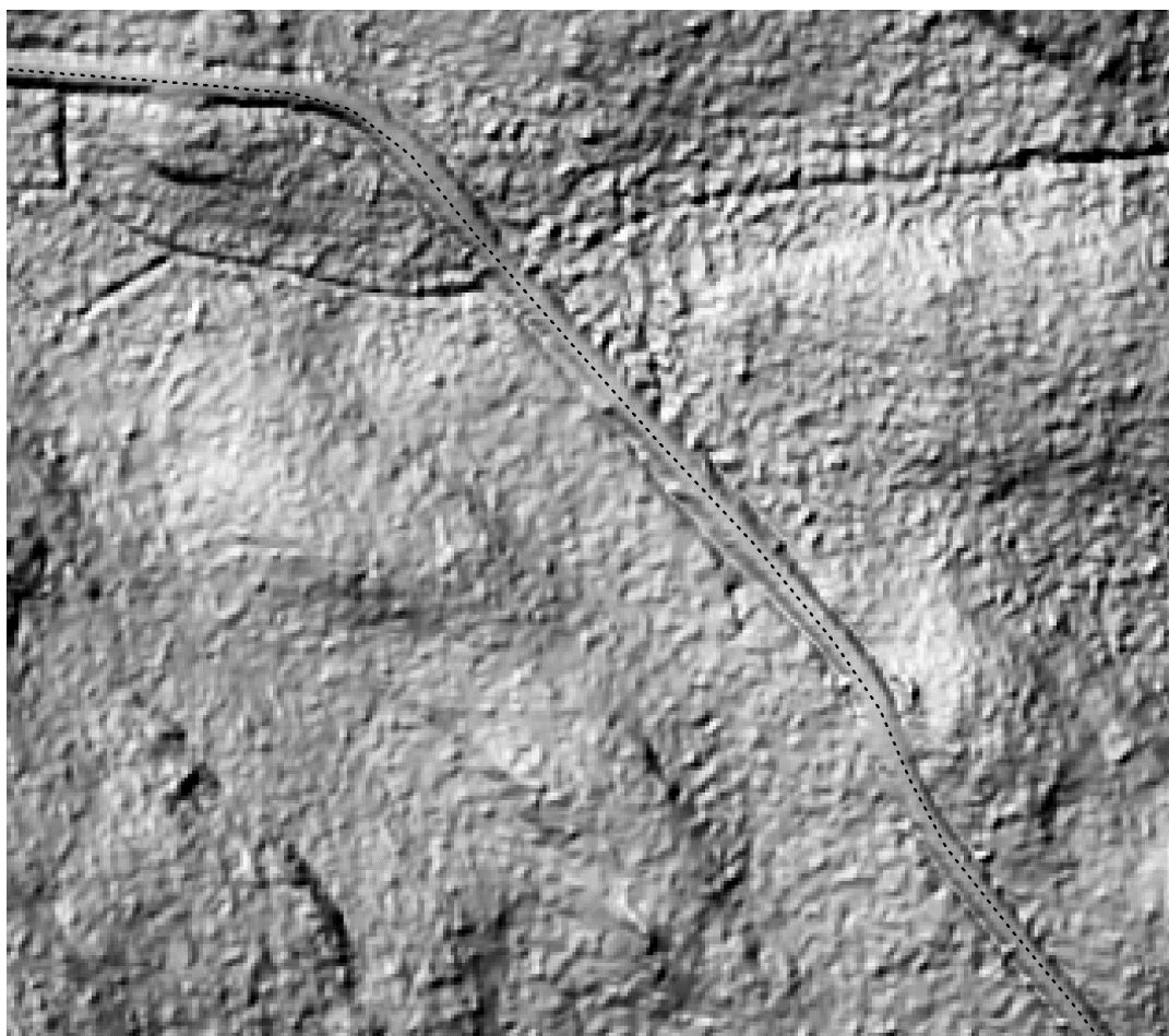
Kuva 7. Tienvarsojasto näkyy himmeästi tien vierustassa. Tien keskilinja kuvattu katkoviivalla.
